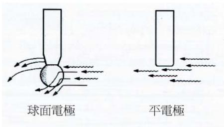
平電極有抗磨損作用，原因微粒急速略過平坦表面而不會撞擊易碎的 pH 敏感玻璃。但球面電極的上游面會不斷受撞擊導致磨損、校準漂移或可能破損。
