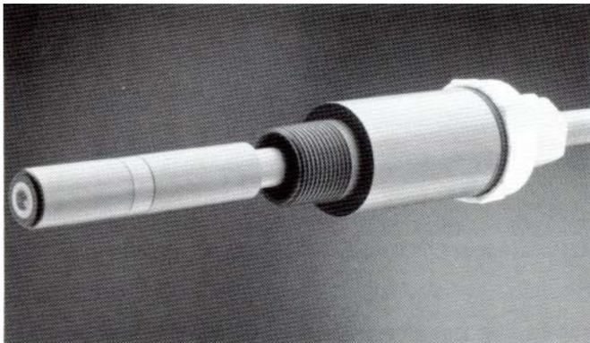
插入式組件使能在加壓缸及主管道上測量 pH 而維修電極時不需要停掉整個系統。並可調校插入深度使其處於湍流位置從而做到自我清洗功效。在磨蝕的應用，電極通常要處於與管壁貼近。這很適合高懸浮固態物液體的測量及黏性液體的測量。
