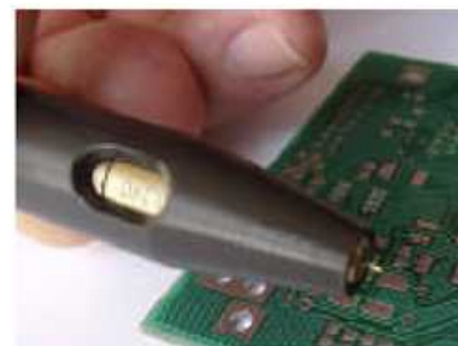
EP-20 PTH 孔壁厚度測量探針
