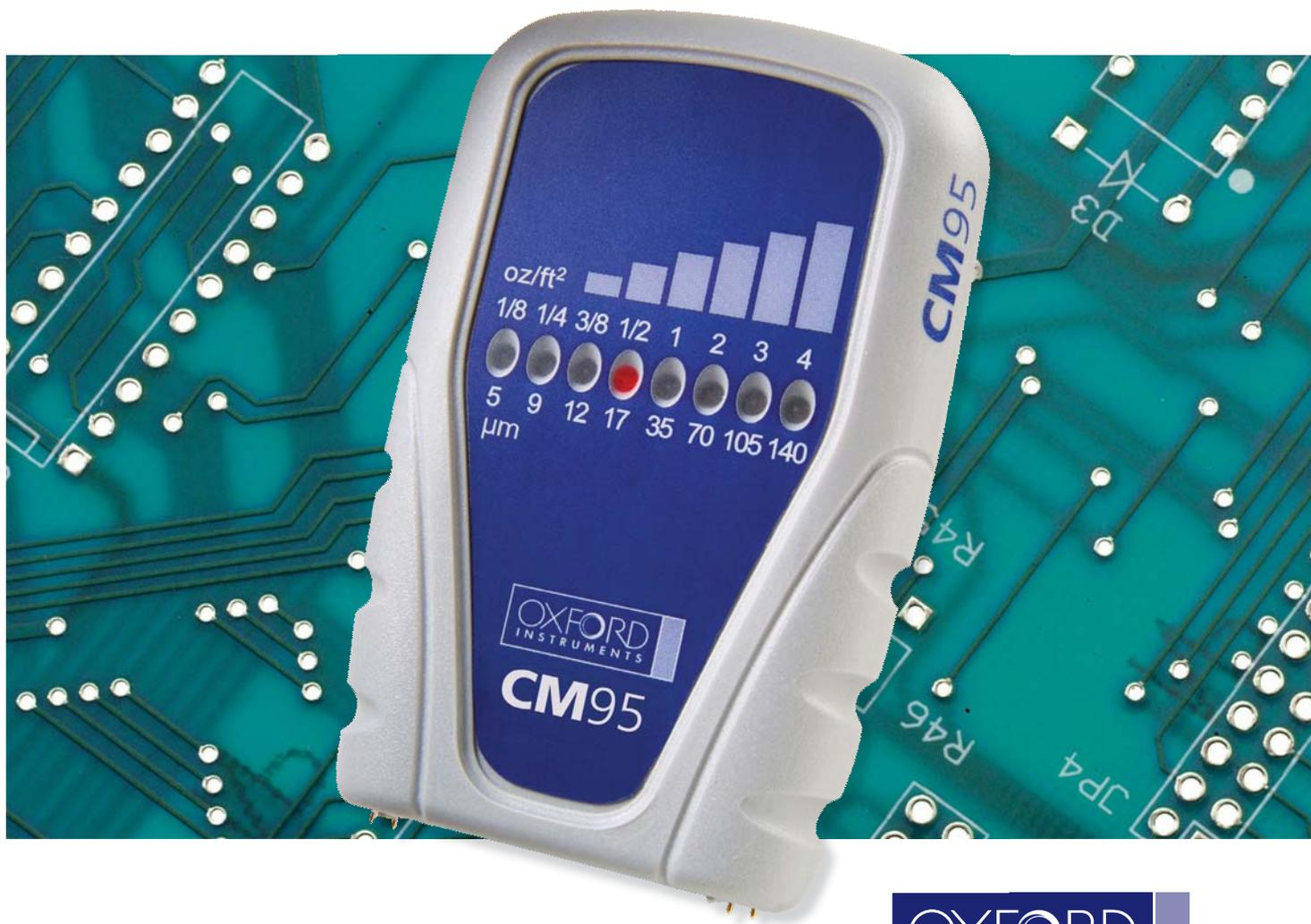
牛津仪器公司推出的**CM195M**是一款为测试铜箔厚度设计的电池供电的手持式测厚仪，它能够在一秒钟之内测量印刷电路板上的铜箔厚度，范围从1/8 到4.0 盎司/平方英尺（5-140 微米）。
